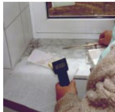
**Bild 6.4- 5:** Permanente Kaltluftströme durch geringe Luftundichtheiten zwischen Fensterrahmen und Fensterbank kühlen die Fensterbank ab und erwecken den irrigen Eindruck, die Marmorfensterbank selbst sei kalt (vgl. Bild 6.4-4).
