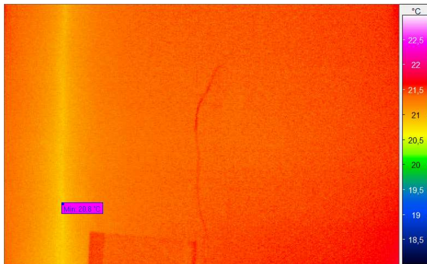
Abbildung 78: Thermogramm aus dem Arbeitszimmer, dem Raum in der Dachgeschoss Nord-west-Ecke. Die operative Raumtemperatur liegt hier um 21,5 °C; in der Kante fallen die Temperaturen bis auf minimal völlig unkritische 20,8°C ab. Das Kabel im Bild ist die Zuleitung zum Oberflächentempersensor, der unterhalb des Wärmestromsensors angebracht ist. Überhaupt nur im hoch temperaturlaufgelösten Bild sind die Temperaturverläufe an der Außenwandkante (geometrische Wärmebrücke Außenwand Süd an Außenwand West) erkennbar.
