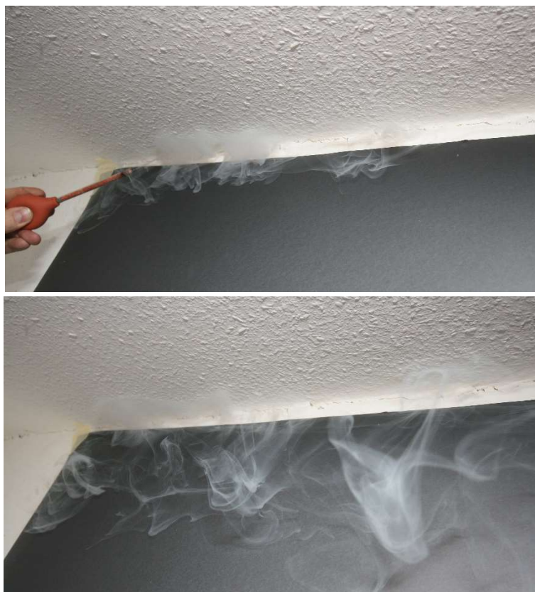
Abbildung 114: „Theaternebel“-Test am Anschluss Dach – Wand bei 50 Pa Unterdruck. In der Nähe des Tapeten-Risses wird Rauch eingeblasen. Es ist keine induzierte Luftbewegung durch einströmender Luft durch den Riss erkennbar. Das untere Bild ist 4 Sekunden nach dem oberen aufgenommen; der Nebel verteilt sich nur ungerichtet. Zur besseren Visualisierung ist ein Bogen schwarze Pappe auf die Wand geklebt worden.
