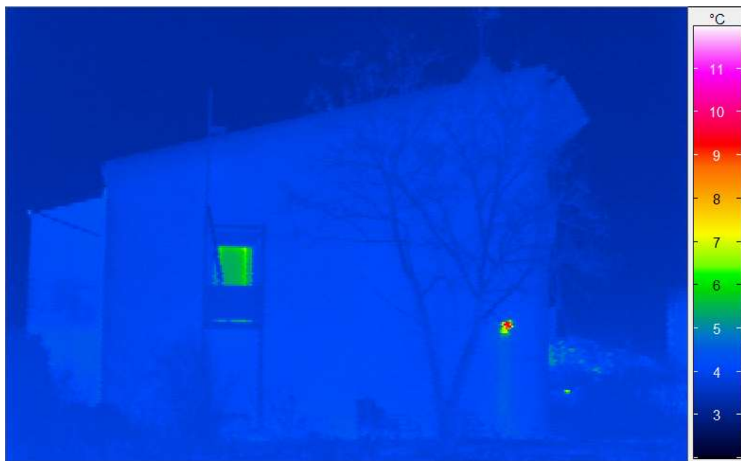
Abbildung 45: Thermographie der Westfassade vom 01.01.2016. Durch den bedeckten (und damit weniger kalten) Himmel entfallen hier die auffälligen Reflexionseffekte gegenüber der Aufnahme von 2001. Weiter erkennbar sind der Fortluftauslass (roter Fleck) und das Nachbargebäude im Hintergrund. Entfallen ist der Schiebeladen. Oben rechts an der Fassade blickt man hinter die neu installierte Photovoltaikanlage. Vor der Fassade ist ein Baum hochgewachsen. Für die gedämmte Fassade, die Anschlüsse zum Dach, die Integration des Fensters zeigt das Bild in der gesamten Fläche eine vollständig homogene Temperatur: Es gibt keinerlei Hinweise auf Wärmebrücken (keine Setzungen, Abrisse o.ä.) oder veränderte Materialeigenschaften.
