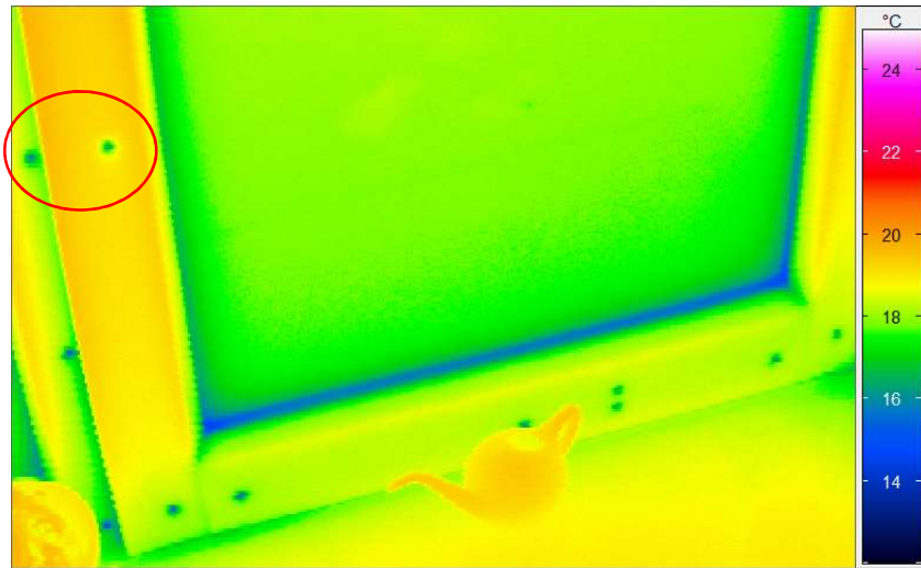
Abbildung 104: Detail-Thermographie des Wohnzimmerfensters. Markiert sind zwei Schrauben, welche zur Materialfeuchtemessung am Rahmen angebracht wurden.
