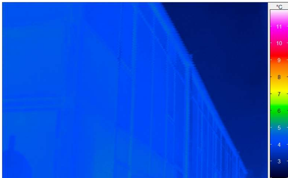
Abbildung 58: Thermographie vom Januar 2016: Glasvorbau auf der Nordseite. Wegen des trüben Wetters sind hier keine ausgeprägten Reflexionen erkennbar. Die Oberflächentemperatur liegt sehr nahe an der Außenlufttemperatur; daher setzt sich hier die Frischluftansaugöffnung (Gitter) kaum ab.
