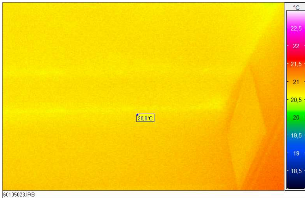
Abbildung 86: Dachanschluss im Flur DG; die Innenwandoberfläche zum Duschbad ist ein wenig wärmer als der Rest der Oberflächen im Flur; die Überströmöffnung für die Abluft hat dagegen erwartungsgemäß Raumlufttemperatur, welche der Temperatur der (leichten) Gipskartonverkleidung des Daches entspricht (20,9 °C). In der vorliegenden hohen Tempertaurlösung sind wieder die Bereiche der Konterlattung mit geringfügig höheren Wärmeverlusten erkennbar.
