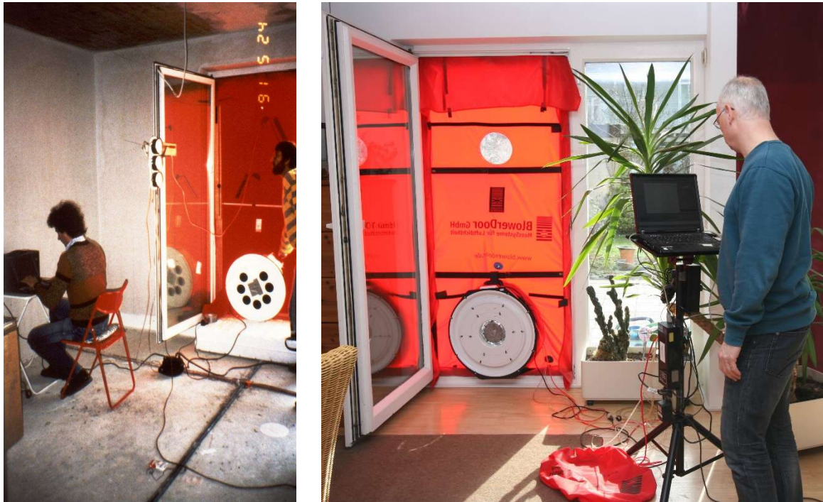
Abbildung 125: Links: Der erste Drucktest wurde nach Fertigstellung der luftdichten Hülle am 24./26.05.1991 durch das Ingenieurbüro ebök durchgeführt.
