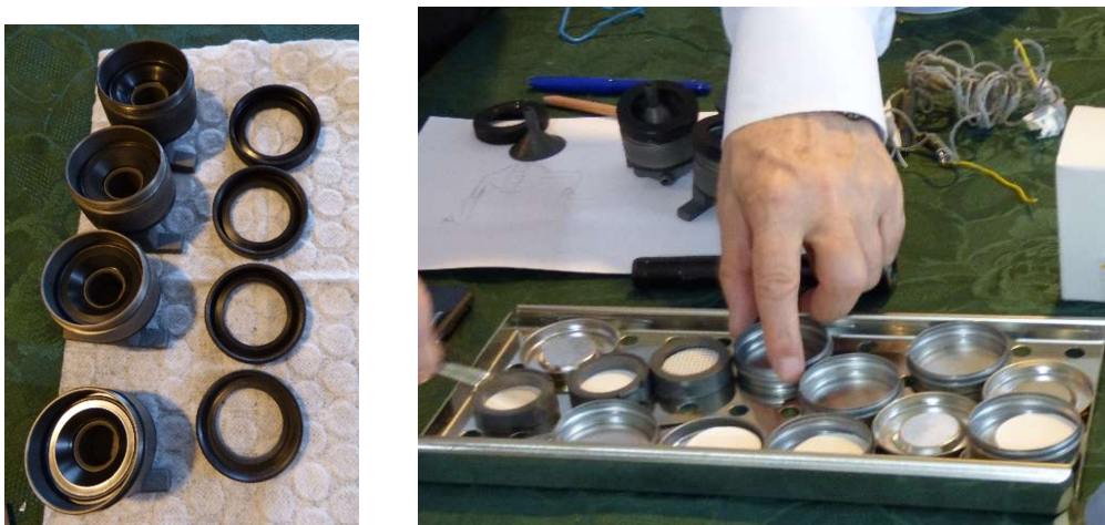
Abbildung 148: Filterhalter und Filter zur isokinetischen Probenahme (rechts: Vorbereitung zur Sterilisierung)
