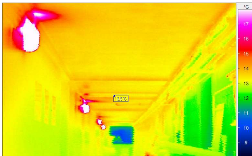
Abbildung 71: Im Mittelgang des Kellers liegen die Raumtemperaturen etwas höher. Die Kellerdecke weist hier an der Unterseite etwa 13,5°C auf. Die etwas wärmeren „Streifen“ sind geometrische Effekte (vertikale Kanten bekommen mehr Zustrahlung von der Decke selbst und weniger vom kälteren Boden). Klar erkennbar sind die Kellerlampen (links) und die von ihnen aufsteigenden Warmluftströme.
