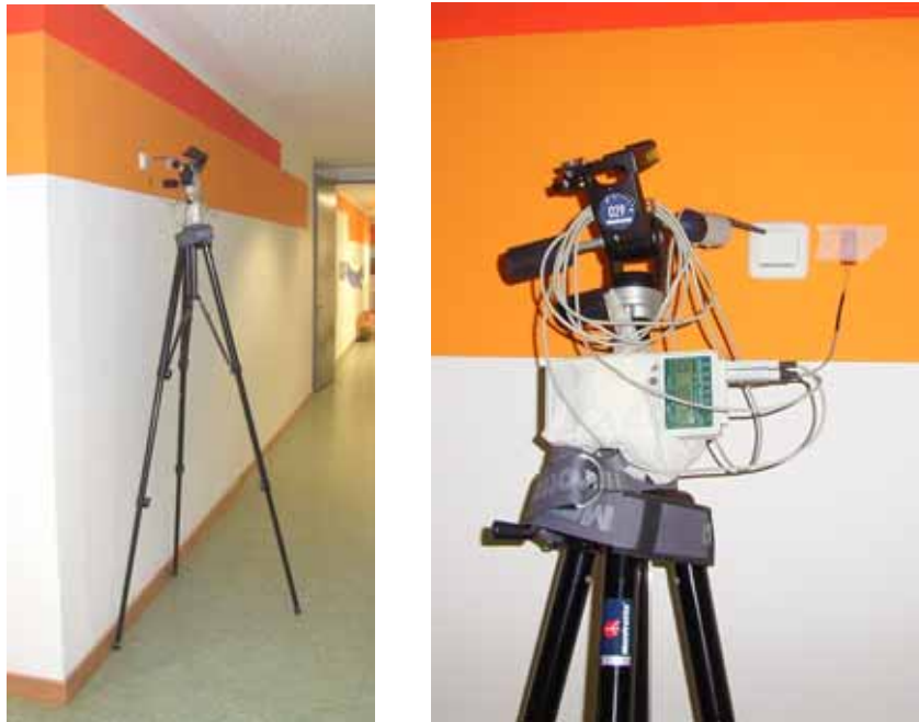
Abbildung 37: Kalibriermessung vom Temperatursensor im Flur vor Raum 0.3.
