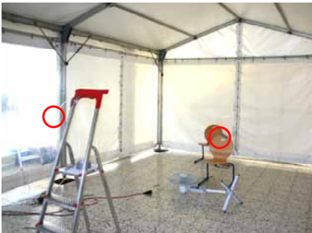
Abbildung 147: Messzelt von innen. Zur Minimierung der Leckagen zum Foyer wurden die Stöße und Anschlüsse des Zeltaufbaus sorgfältig abgeklebt. Über ein Schlauchsystem werden Luftproben aus dem Zeltvolumen entnommen. 2 Schlauchenden sind mit Kreisen markiert (links). Der Ventilator (links) sorgt für eine gute Durchmischung der mit Indikator angereicherten Luft im Zeltvolumen.
