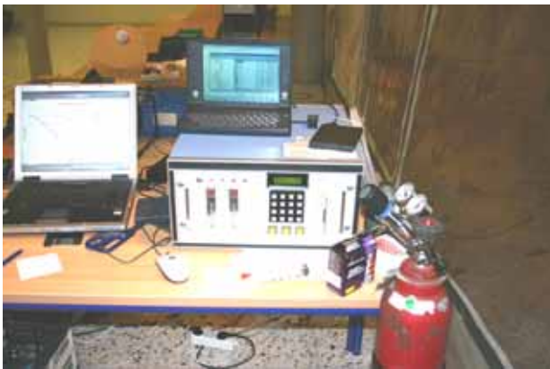
Abbildung 146: Messaufbau zur Konzentrationsabfall-Messung. Der Verdünnungsverlauf wird in einem sorgfältig abgedichteten Zelt im Schulfoyer gemessen. Indikatorgasmonitor (links) / Zelt vor Haupteingang (rechts)
