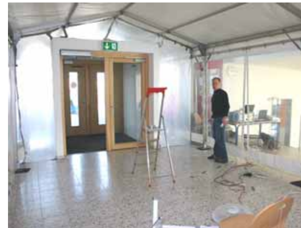
Abbildung 147: Messzelt von innen. Zur Minimierung der Leckagen zum Foyer wurden die Stöße und Anschlüsse des Zeltaufbaus sorgfältig abgeklebt. Über ein Schlauchsystem werden Luftproben aus dem Zeltvolumen entnommen. 2 Schlauchenden sind mit Kreisen markiert (links). Der Ventilator (links) sorgt für eine gute Durchmischung der mit Indikator angereicherten Luft im Zeltvolumen.
