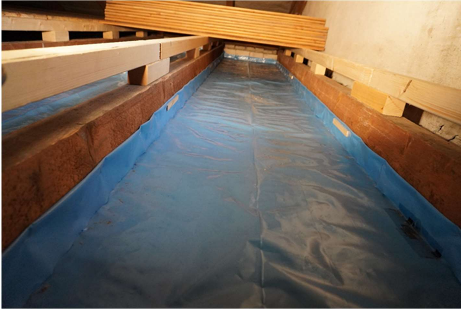
Testbahn mit Dampfbremse
